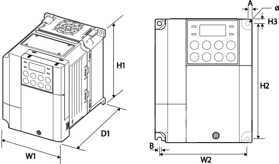
0.8kW-1.5kW(Single Phase 200V), 1.5kW-2.2kW(3-Phase 400V) EMC filter Type
