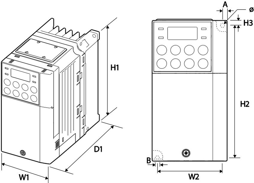
0.8kW-1.5kW(Single Phase 200V), 1.5kW-2.2kW(3-Phase 400V) EMC filter Type
